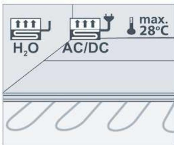
Перед тем как приступить к монтажу, внимательно изучите инструкцию по укладке. Рекомендуется использовать системы напольного водяного или электрического отопления (температура поверхности пола - max. 28°C).
