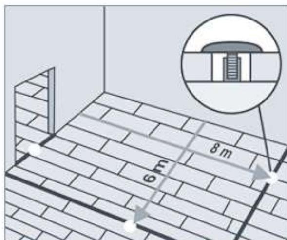
Рекомендуется укладывать ламинированные полы по направлению падения света из окна. В помещениях длиной более 8 м и/или шириной более 6 м необходимо предусмотреть деформационные зазоры не менее 10 мм. После укладки ламинированных полов деформационные зазоры закрываются специальным профилем.
