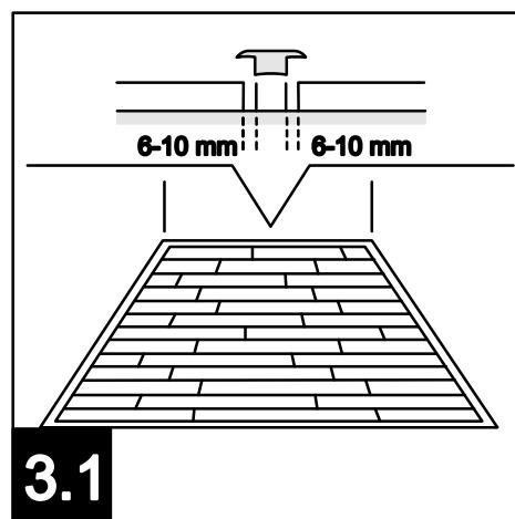
Есть особые случаи, когда требуется устройство дополнительных расширительных швов, которые закрываются стыковочным профилем (порожком):
